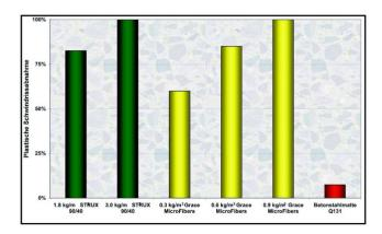
Hinweis: Auch wenn dem Beton STRUX 90/40-Fasern zugegeben werden, um eine Kontrolle der plastischen Schwindrissbildung zu erreichen, ist eine Nachbehandlung des Betons nach den anerkannten Regeln der Technik durchzuführen.
